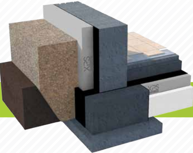
Detail zateplení podlahy a podzemní stěny ve styku se zemí
