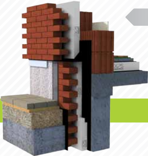
Detail zateplení stropu nad nevytápěnou místností
